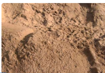
CÁT VÀNG HẠT LỚN ĐỔ BÊ TÔNG
